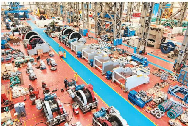
1月8日，工人在江苏南通振华重工南通传动大型海工车间内生产三峡风电施工船重吨绞车和升降系统。
