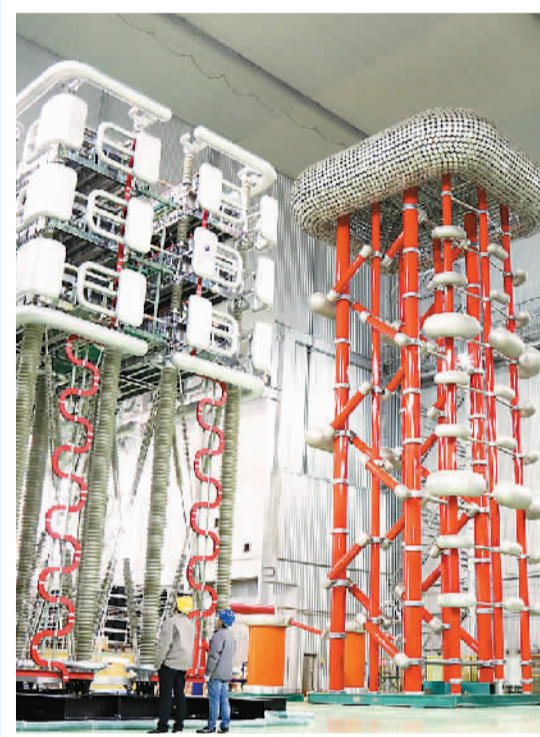
科研人员在国家重点实验室对柔性直流换流阀进行试验。
