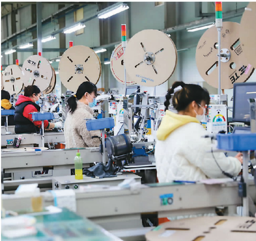
▲安徽淮北市高新技术产业开发区一家外资企业内，工人在车间生产汽车电子线束产品。 万善朝摄（新华社发）
