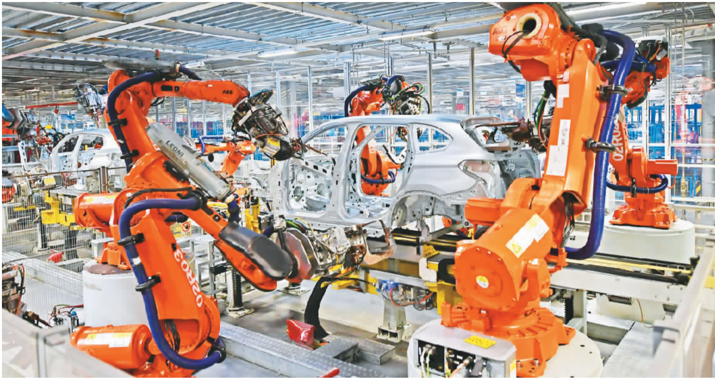
▲日前，华晨宝马沈阳铁西工厂车身车间，机器臂在焊接车身。 新华社记者 杨青摄
