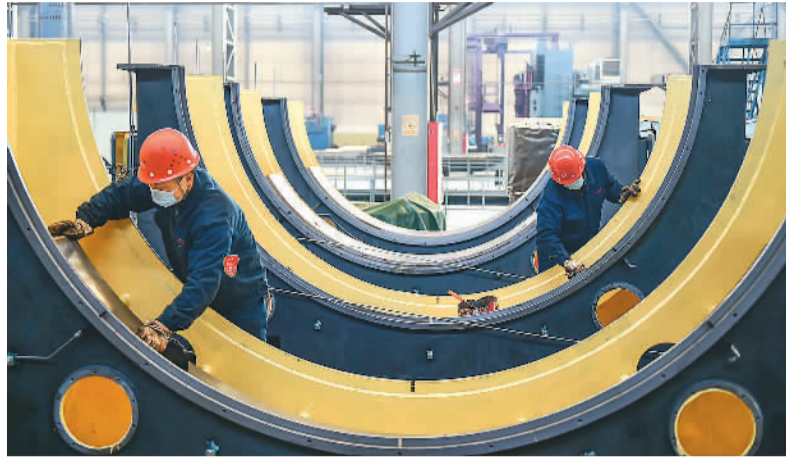
1月1日,在位于河南洛阳的中信重工生产线上,工人组装一批矿用磨机轴承座。 黄政伟摄(人民视觉)
