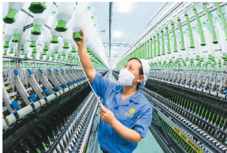
江西省瑞昌市华瑞(中国)缝纫线有限公司是该省全流程自动化、智能化的纺纱生产线企业。目前, 公司新生产线已实现生产自动化、技术控制智能化, 提高了生产效率和水平, 助力企业高质量发展。图为日前工人在生产车间更换粗纱。
