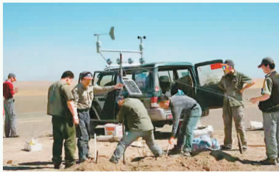
研究人员在库姆塔格沙漠架设测风站。
