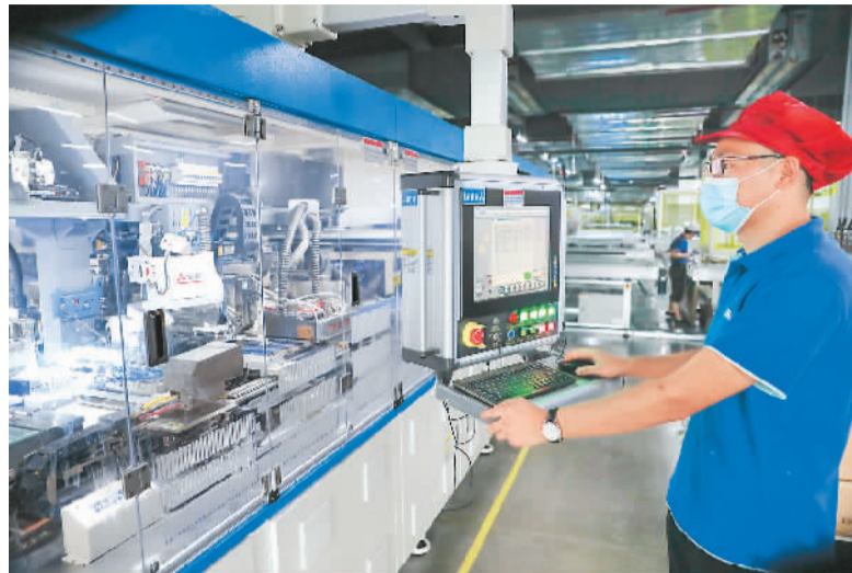
安徽大恒能源科技有限公司今年投资6000万元新增2条全自动化生产线，用于生产创新专利产品“全面屏组件”“低电流组件”以及全球首创的微单元智能光伏系统等。图为工人正在操作自动串焊机。 赵明摄(人民视觉)
