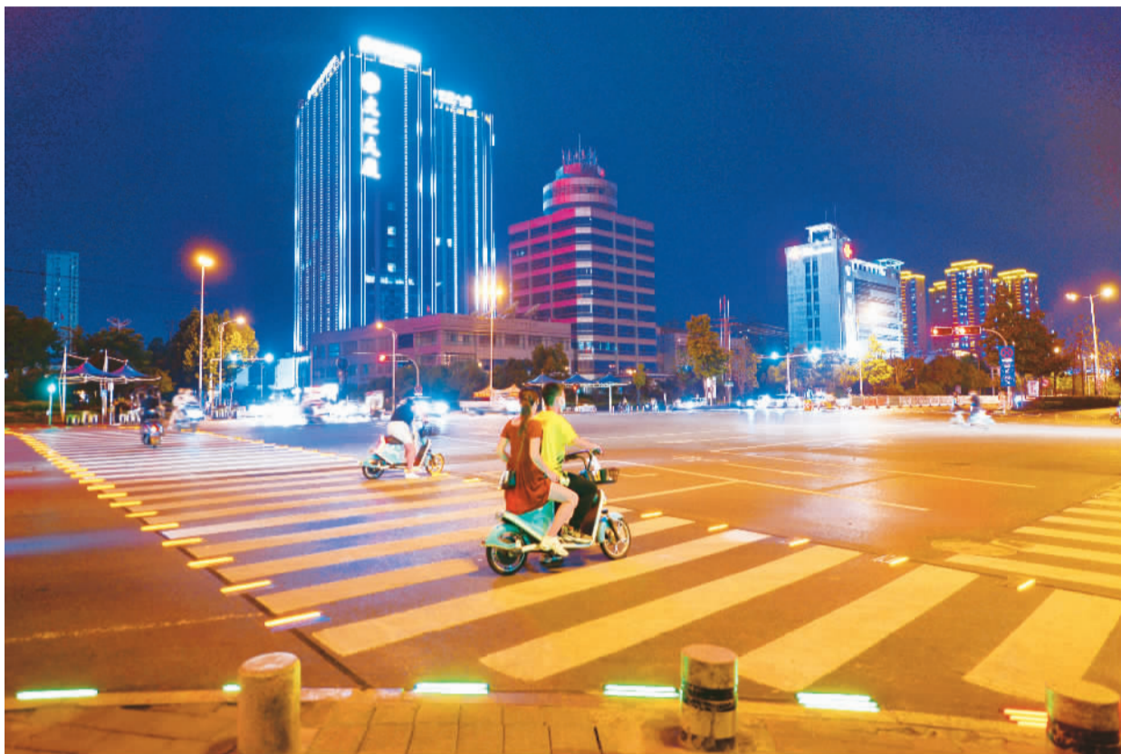
6月14日晚，一条可发光的智慧斑马线在安徽省六安市城区梅山南路与长安路交叉口闪亮上岗，为行人安全过马路保驾护航。该设备与交通信号灯同步联动使夜晚的人行道更加醒目，提示机动车减速慢行礼让，警示行人按交通信号灯安全通行。田凯平摄（人民视觉）
