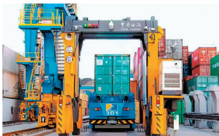
图为海关设置在自动化码头的先期机检设备，能实现对集装箱的顺势监管。
