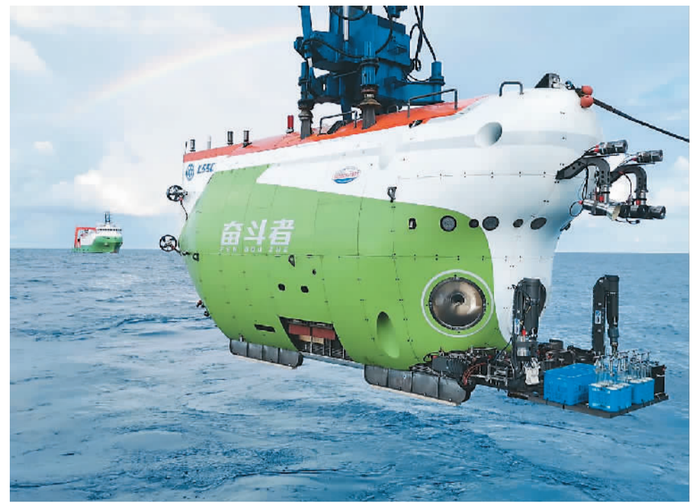
2020年11月28日，由中国船舶集团制造的创造了10909米中国载人深潜新纪录的“奋斗者”号，完成第二阶段海试，胜利返航。图为“奋斗者”号。中国船舶集团供图（新华社发）
