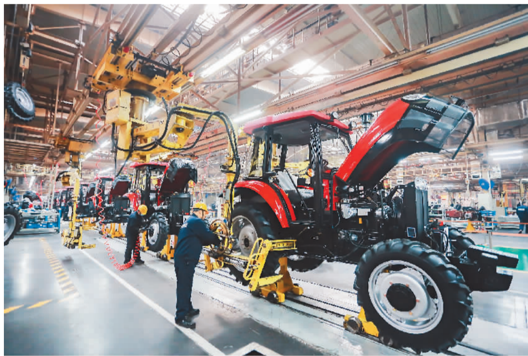
在中国一拖大轮拖生产线上,自主研发的新一代“东方红”拖拉机正在装配。
