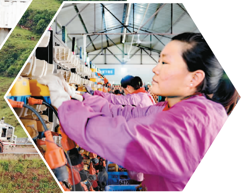
▲工作人员在数据下载中心下载eSeis节点仪器采集数据并充电。
