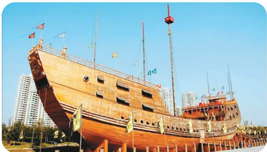
“仿明代郑和宝船”位于江苏南京宝船厂遗址公园，具有良好的适航性和稳定性，可用于远洋航行。船体采用中国传统捻缝工艺，捻缝材料主要为纯正桐油、壳灰、竹丝粉等，按比例混合后用打灰机反复捶打成熟。 闵捷摄
