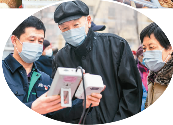
▲江西省南昌市市场监督管理局执法人员在红谷滩沁园农贸市场使用2KG重的砝码对市场内的电子秤进行检测。
