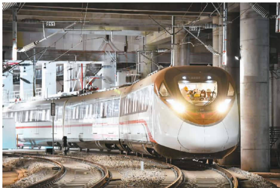
广州地铁18号线时速160公里的电客车在进行热滑试验。 新华社记者 刘大伟摄
