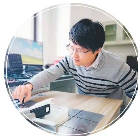
张留洋正在进行铝板裂纹检测实验。
