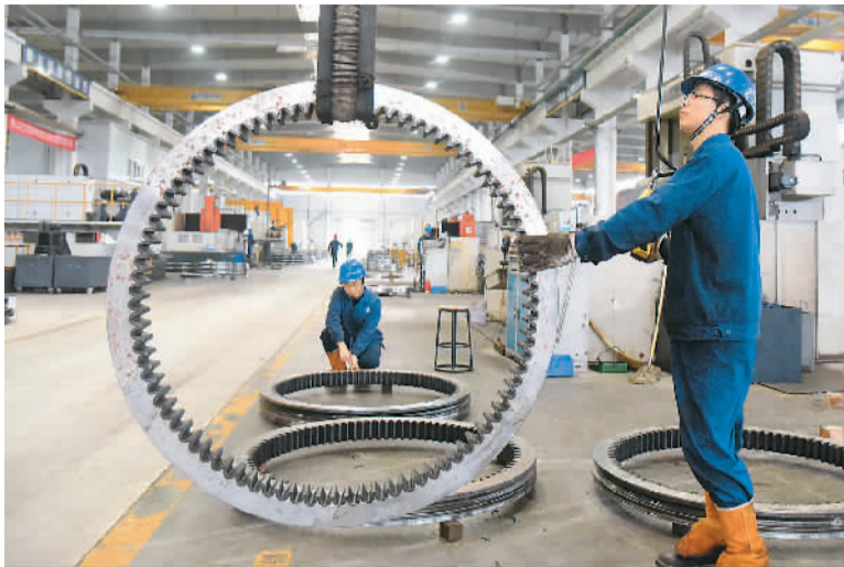
安徽省马鞍山经济技术开发区发展新能源及节能环保产业，助力企业转型升级和高质量发展。图为4月1日，马鞍山方圆精密机械有限公司员工在加工多款为风电、医疗等行业“量身定制”的回转支承产品。 胡智慧摄（人民视觉）
