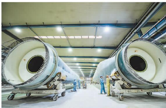
近期，位于内蒙古鄂尔多斯市东胜区的鄂尔多斯装备制造工业园区各部门为企业提供精准服务，助力企业提质升级。图为园区内一家新材料科技股份有限公司的工人正在进行风叶壳外部补强作业。
