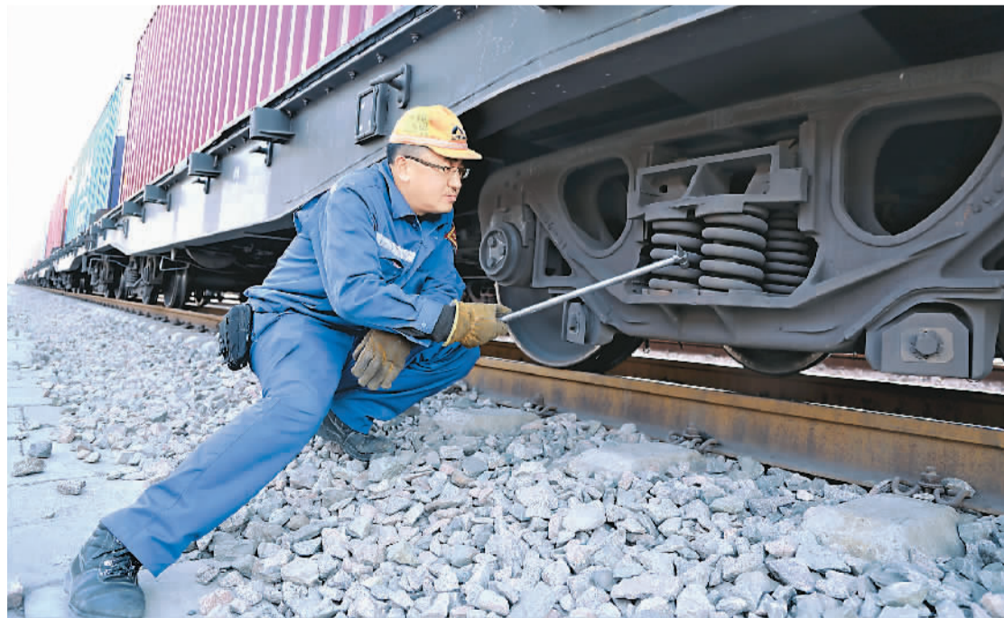
图为兰州西车辆段货车检车员正在检查中欧班列的车轮走行部技术状态。兰州西车辆段供图
