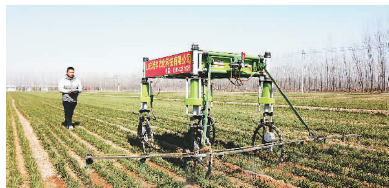
在山东省邹平市粮食提质增效关键技术攻关项目集贤镇解家村基地，农民用“智慧娃”植保机器人给麦田喷药。
