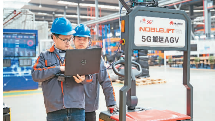
2月20日，浙江长兴诺力智能装备股份有限公司智能工厂，工人们正在调试5G无人驾驶AGV叉车。王晋斌摄（人民视觉）
