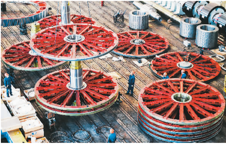
不久前，位于河南洛阳的中信重工装配车间内，工人正组装一批直径5米的多绳摩擦式矿井提升机天轮装置。黄政伟摄（人民视觉）
