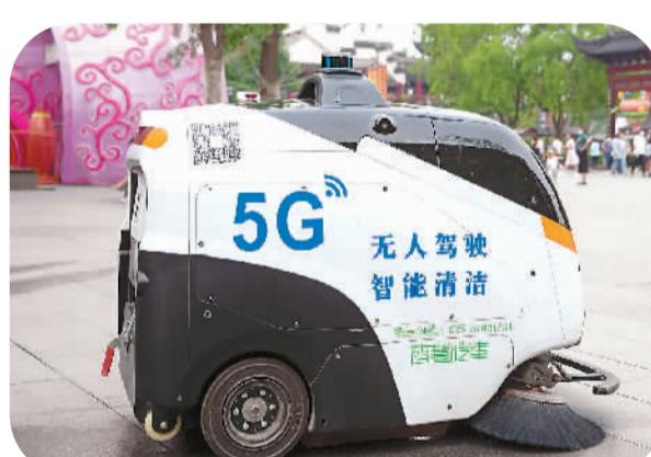
一台无人驾驶清扫车亮相南京夫子庙景区。据悉，这款清扫车采用智能AI技术和无人驾驶技术等，可自主在路面上完成清扫、洒水、垃圾收集等工作。图为无人驾驶清扫车在南京夫子庙景区内进行清扫作业。
