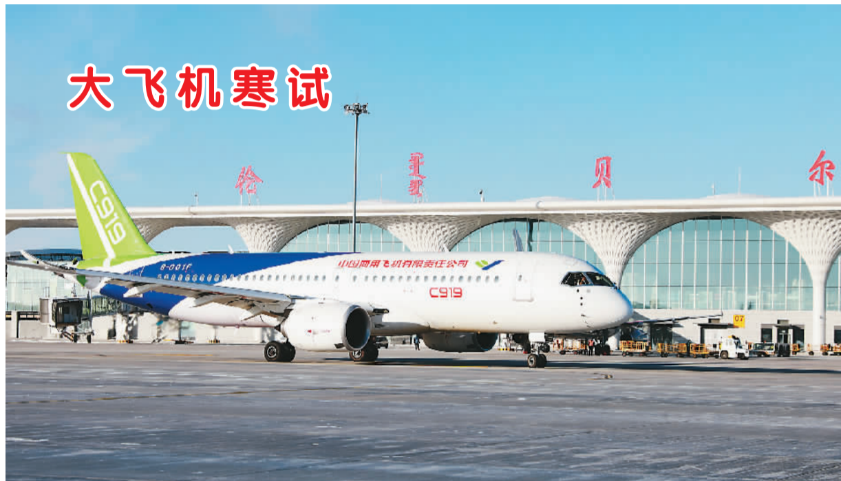
12月25日,中国商飞C919大型客机抵达内蒙古自治区呼伦贝尔市,全面开启高寒专项试验试飞,旨在验证飞机在极寒气象条件下各系统和设备的功能和性能符合适航标准。 张彬 佟欣摄影报道
