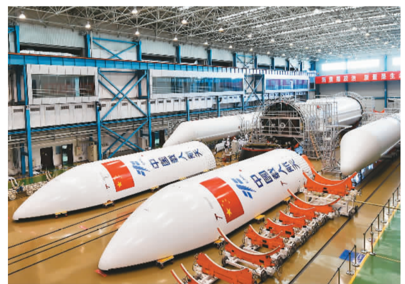
天津大运载火箭基地位于天津经济技术开发区，由火箭研制生产区、航天技术应用产业区和辅助配套区三部分组成，集火箭零部件生产、部组件装配、总装测试与试验于一体。图为长征五号运载火箭总装车间。孙凡越摄（新华社发）
