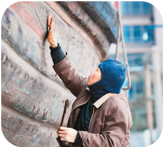
福船造船技艺人用防水桐油灰填满福船的缝隙和钉孔 新华社记者 魏培全摄
