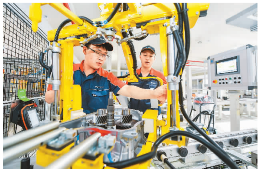
10月19日，在浙江湖州长兴经济技术开发区吉利动力总成长兴制造基地，技术人员正在忙碌生产拥有完全自主知识产权的全新一代7DCT双离合自动变速器。 谭云伟摄（人民视觉）
