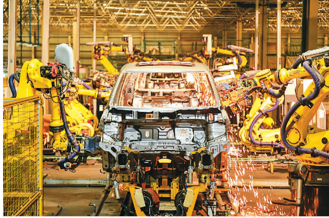
在海南自贸港建设加快推进背景下，一汽海马汽车有限公司加快在海南布局，向新能源汽车、智能汽车生产商转型。图为11月5日，海马汽车海口基地的焊接车间内，机器人在生产线上进行焊接工作。 王程龙摄（人民视觉）
