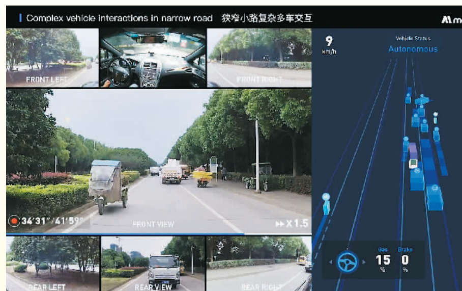
▲生活中,迎面逆行三轮车、压线行驶的货车是较为典型的长尾场景。左侧为人眼看到的现实实景,右侧为车辆“大脑”构建的模型图,每个物体前的延长线为系统对其活动预测的轨迹,避免各轨迹间发生碰撞,是自动驾驶的重要规则之一。图为初速度在苏州路测时记录下的视频。初速度供图
