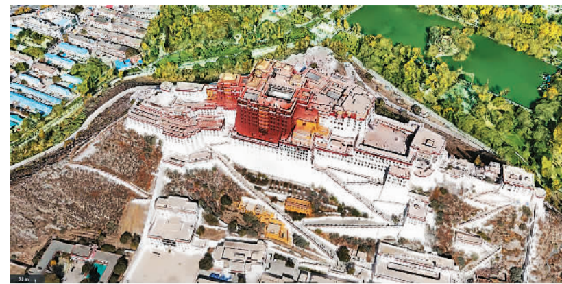
利用无人机搭载高分辨率相机获取的一组带有坐标信息的布达拉宫倾斜影像，这种模型效果逼真、要素全面，而且具有测量精度，是三维扫描的现实应用。图为布达拉宫实景三维模型。
