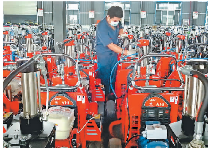
近日，在位于江苏赣榆经济开发区内的江苏三旗流体设备有限公司，工人正检验一批即将出厂的高压无气喷涂机。
