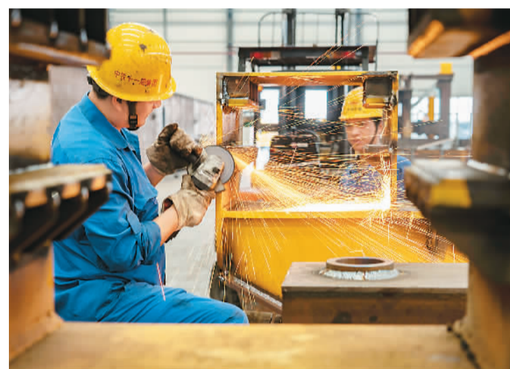
近年来，中铁十一局集团汉江重工有限公司瞄准发展机遇，进军千吨级高铁箱梁施工装备市场。图为该公司生产厂区内，工人在打磨架桥机部件。 新华社记者 杜华举摄
