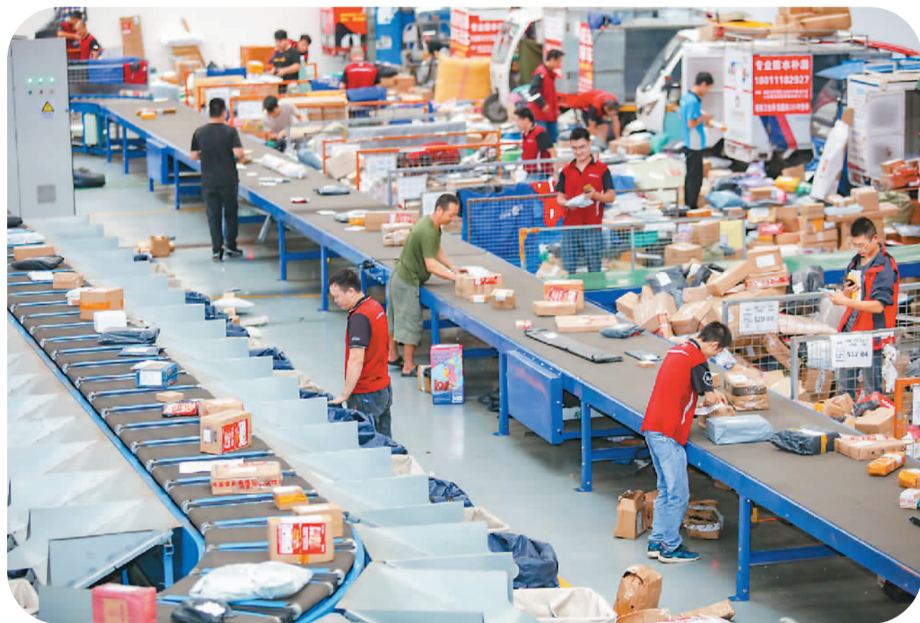
四川省遂宁市高新区四川遂捷通物流有限公司仓库内，一台智能全自动交叉分拣设备正在车间作业。该企业自去年购入这台设备以来，快递从分拣到装运由原来的3-4小时缩短至1个多小时，每天最高能分拣10万件，不仅提升了分拣效率，还减少了用工成本。 刘昌松摄（人民视觉）
