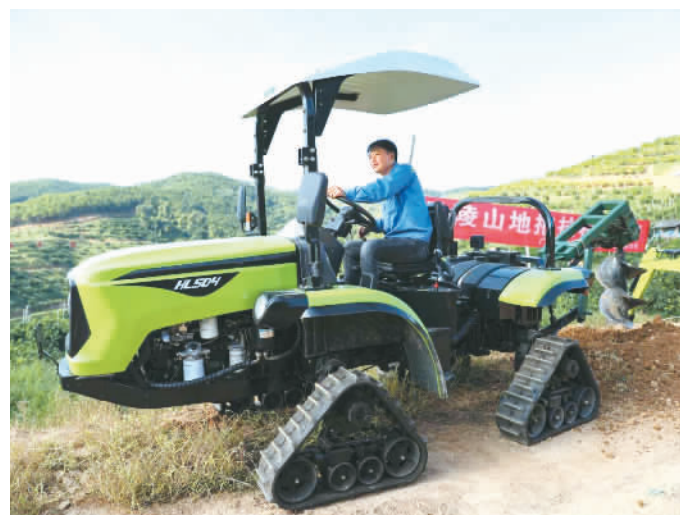
图为履带式拖拉机配套农机具在百色右江区果园挖坑作业。 本报记者 庞革平摄
