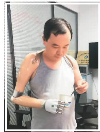
志愿者正在对做意研发的智能机械手进行测试。(受访者供图)
