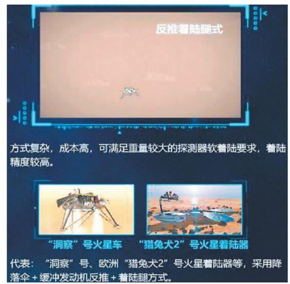
方式复杂，成本高，可满足重量较大的探测器软着陆要求，着陆精度较高。
