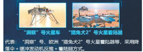
代表：“洞察”号、欧洲“猎兔犬2”号火星着陆器等，采用降落伞+缓冲发动机反推+着陆腿方式。
