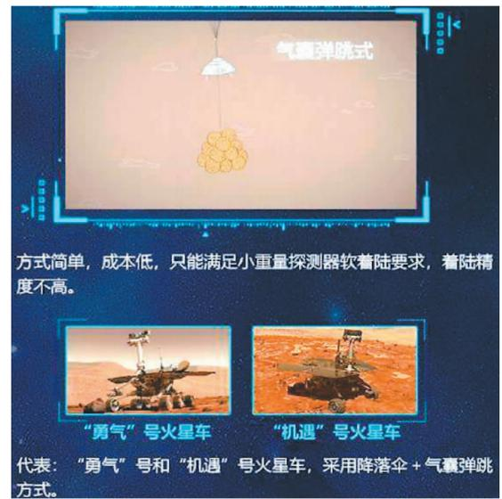
方式简单，成本低，只能满足小重量探测器软着陆要求，着陆精度不高。
