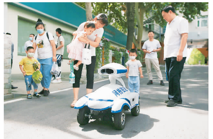
7月21日，智能机器人在山东省济南市乐山区巡逻。它能监控小区噪音、火灾和违章停车等警情并向社区民警传送信息。
