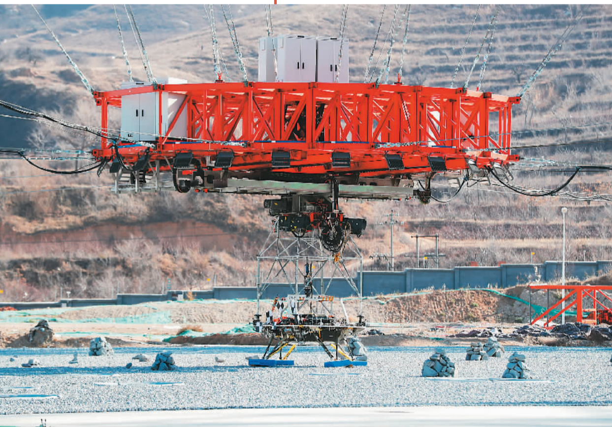
▲ 2019年11月14日,我国完成首次火星探测任务着陆器悬停避障试验。 新华社发
