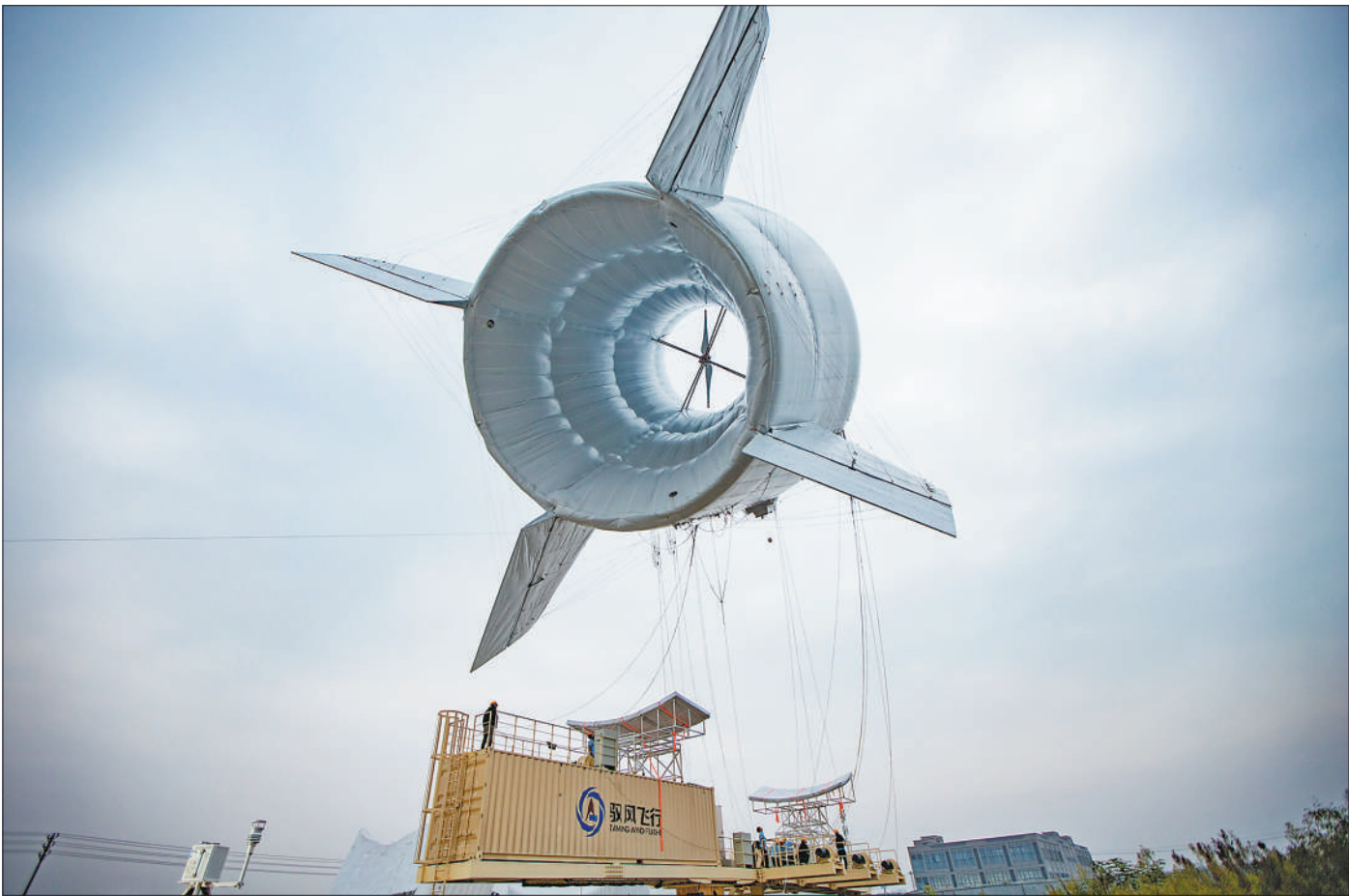
10月15日,在四川省自贡市荣县经开区,一款全天候浮空器进行低空悬驻测试。10月13日至16日,这台由我国科创企业自主研发的浮空器在荣县分时段完成首飞系列试验。这台直径21米、长24米的白色浮空平台将通信中继、导航增强、气象探测等功能集成于同一平台,更好服务经济社会发展。
