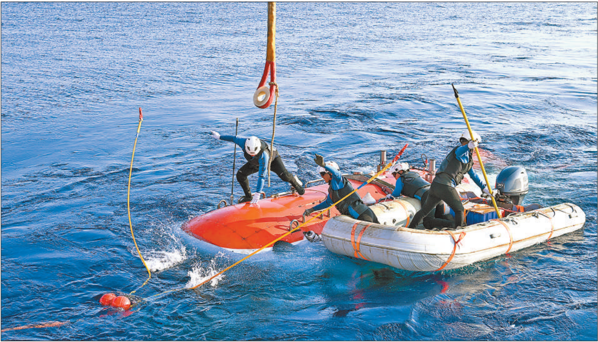
10月10日，搭载“蛟龙”号载人潜水器的“深海一号”船抵达西太平洋东加罗林海盆作业区进行深海科考作业。这是“蛟龙”号的第466次下潜作业，也是中国大洋100航次第二航段科学考察在这片区域进行的首个潜次，计划下潜深度约4500米。图为蛙人团队解除龙头缆，“蛟龙”号脱离母船。 新华社记者 李鑫摄
