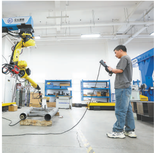
▲工业机器人广泛应用于生产制造。图为全人智能公司内，工作人员在调试工业机器人产品。本报记者 张武军摄
