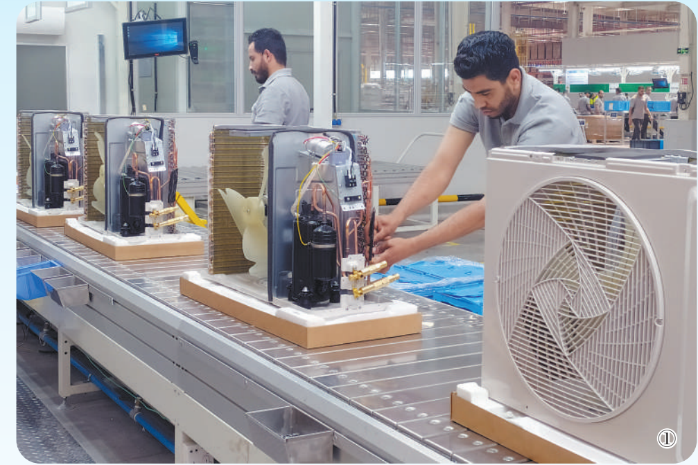
图①：斋月十日城海尔埃及生态园车间内，工人们正在空调生产线上作业。
