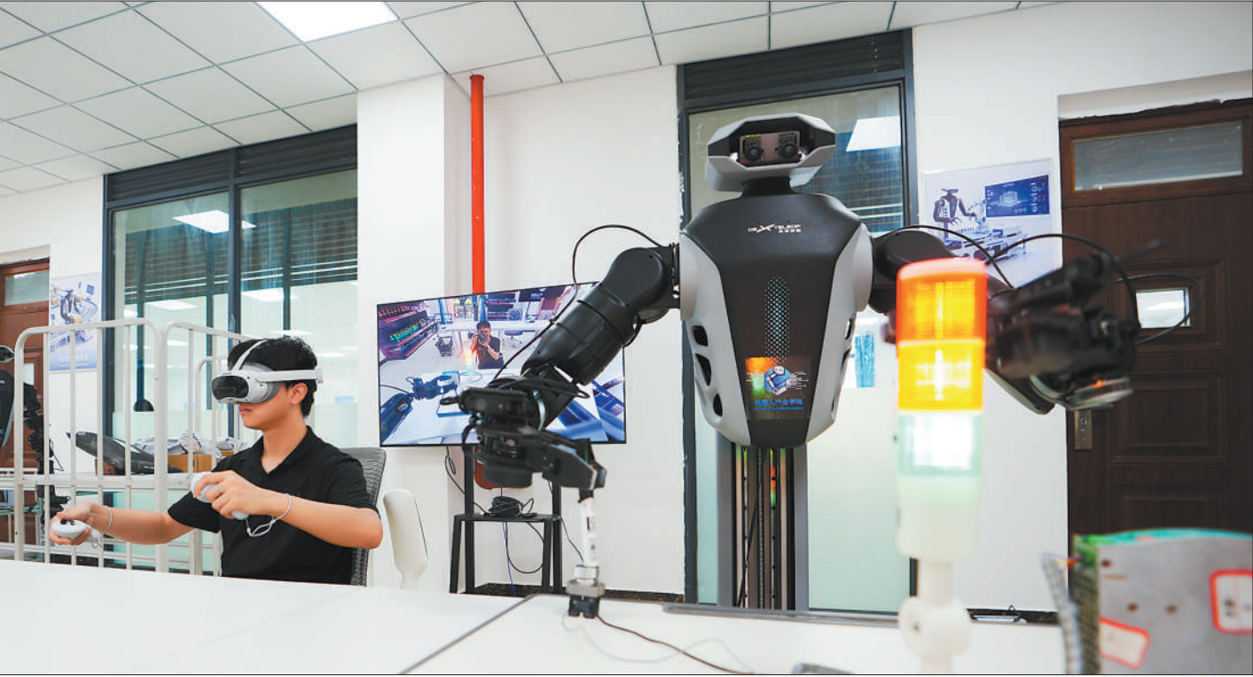
四川科技职业学院学生操控机器人,模拟电力工人进行电路测试。 翁光建摄(影像中国)
