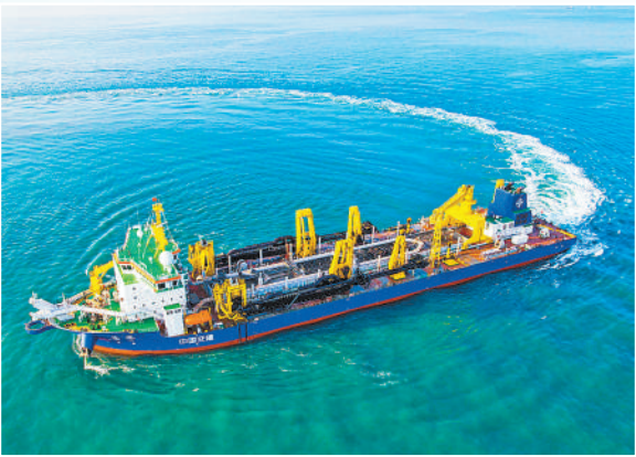
▲“同济”号是由我国自主设计研发建造的超大型耙吸挖泥船。该船配备国内先进智能疏浚系统，成功攻克挖泥船操作员“看不见”水下土质的难题。图为“同济”轮在海试。
