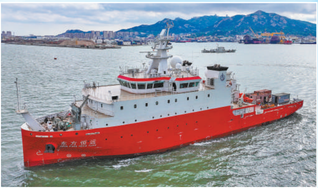
▲“东方恒远”号海上航天发射指挥测量船是国内首创、面向海上航天发射全流程任务量身定制的高端海工装备。图为“东方恒远”号下水试航。
