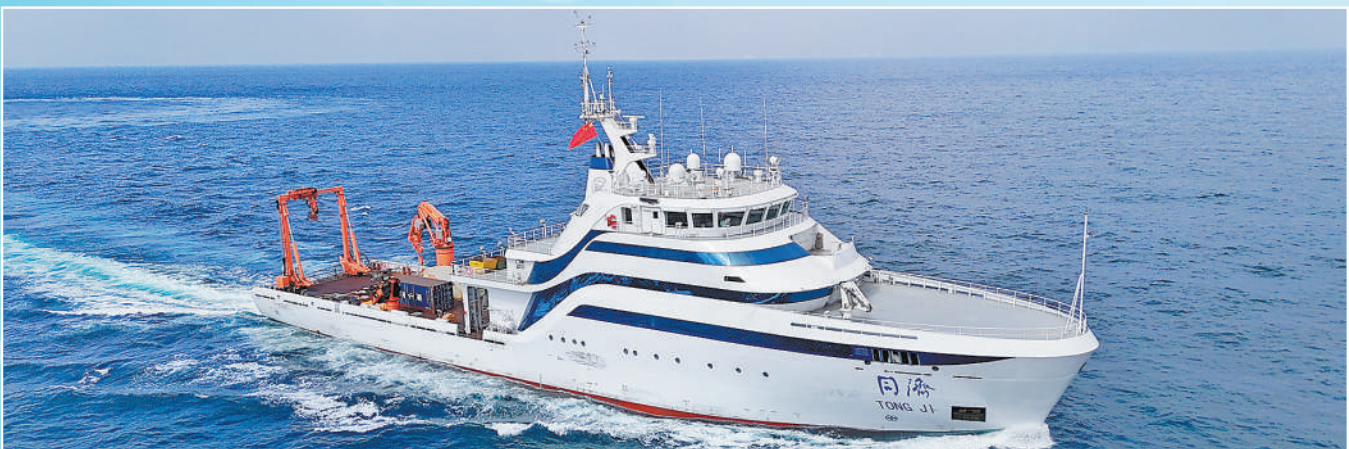
▲“同济”号是国内首艘取得中国船级社智能船舶规范4个智能符号的海洋级综合科考船。该船依托高速通信网络与智能算法可实现开阔水域自主航行、智能避碰、岸基远程操控。图为“同济”号在航行中。
