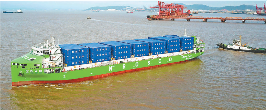
▲“宁远电驱”轮是全球最大、国内首艘万吨级纯电动智能集装箱海船。该船采用10个标准化箱式电池作为核心动力，总储电量约2万千瓦时，实现零排放、零噪声、零污染。该船投用后，预计每年可节约燃油580吨，减少二氧化碳排放量超1400吨。图为“宁远电驱”轮从宁波舟山港北仑港区启航。
