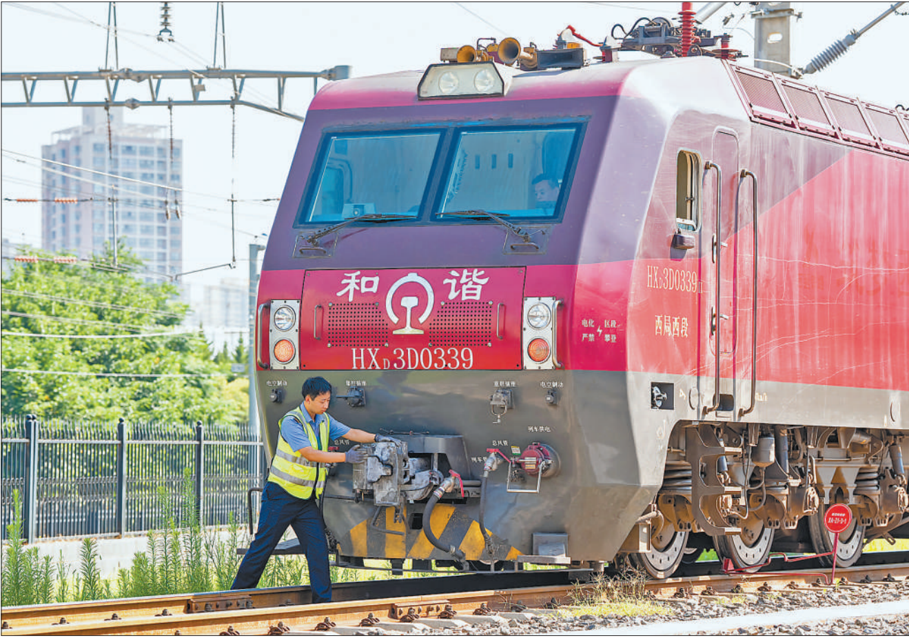
7月8日，陕西西安，机车乘务员正在检修库前检查机车车钩状态。连日来，西安及周边地区持续高温。为保障旅客列车有序开行，铁路部门对客运机车开展全覆盖细致检修、标准化整备作业。
