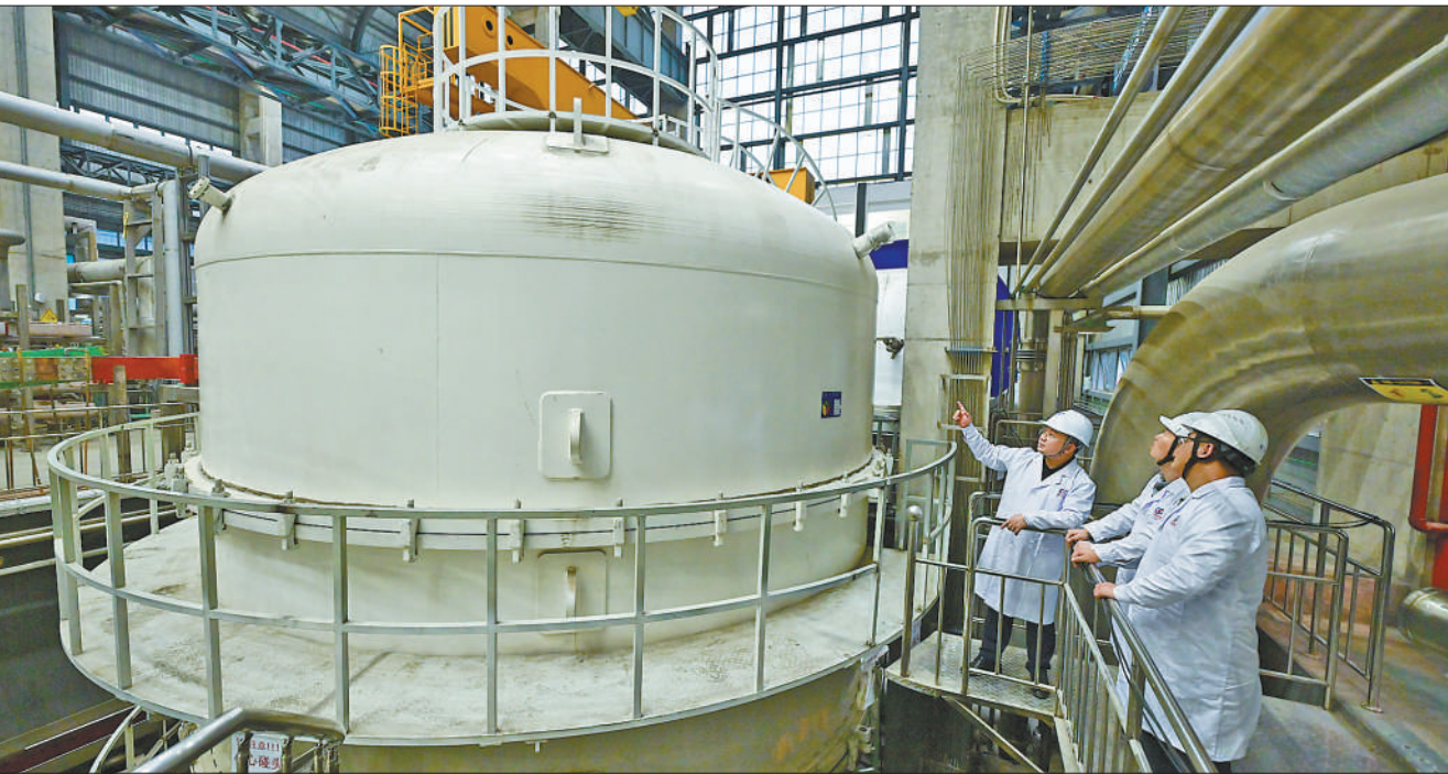
6月27日，中国科学院合肥物质科学研究院等离子体物理研究所“人造太阳”项目取得最新进展，聚变堆环向场超导体、高温超导中心螺管线圈等两套聚变堆关键超导磁体先后完成研制验收与满参数测试，核心技术实现100%国产化，综合性能跃升至国际前列。图为26日，科研人员在检查高温超导中心螺管线圈测试平台。
