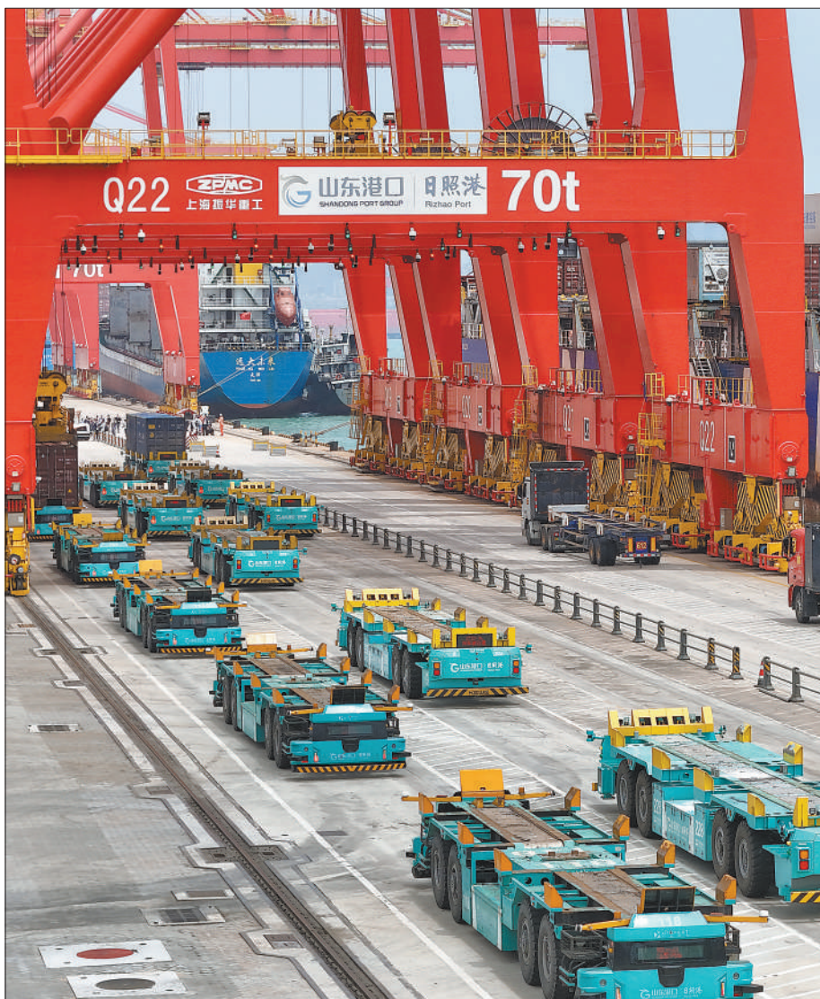
山东港口日照港，无人驾驶智能引导运输车依托“北斗+5G”与人工智能调度系统接运集装箱。唐克摄(影像中国)
