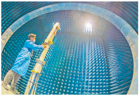
在中国信科集团无线产业园的多探头球面近场检测实验室内,技术人员正利用精密测试系统,对通信基站天线产品进行全面性能检测与校准。
