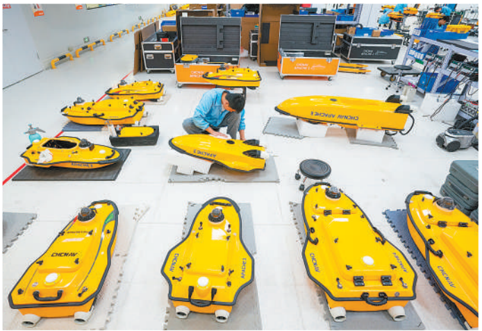
位于光谷的武汉华测卫星技术有限公司,技术人员在组装测试北斗高精度无人船水下测量系统。
