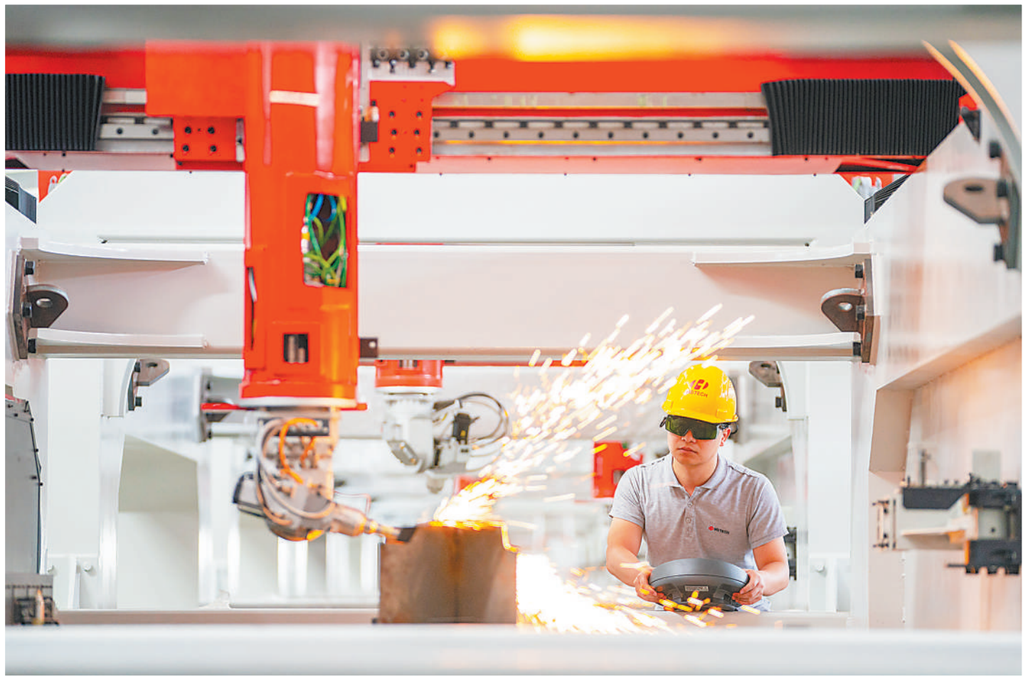
华工科技智能装备产业园,工程师正在调试一套将出口欧洲的三维五轴激光切割机床。该产品实现关键核心部件全国产化,综合性能、市场占有率均全球领先。
