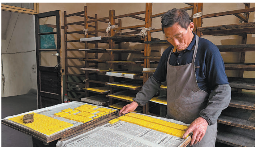
▲安徽黄山屯溪胡开文墨厂，师傅正在晾墨车间翻晾徽墨。俄罗斯籍游客 利娜摄
