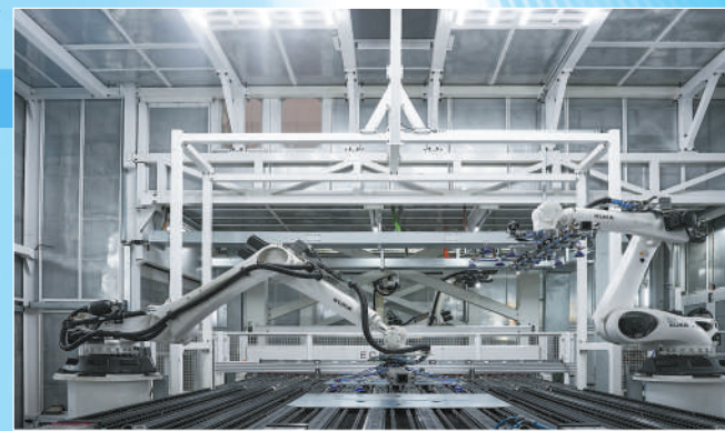
北京亦庄小米汽车工厂冲压车间,视觉引导机器人实现板材精准对中。 曹雨婷摄(人民视觉)
