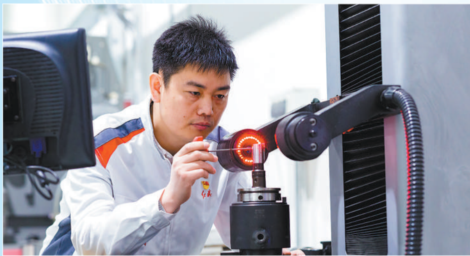
全国人大代表、中国一汽首席技能大师杨永修在调试加工使用的刀具,他通过精研技术将新能源车壳体加工精度控制在0.008毫米以内。 周星宇摄(人民视觉)
