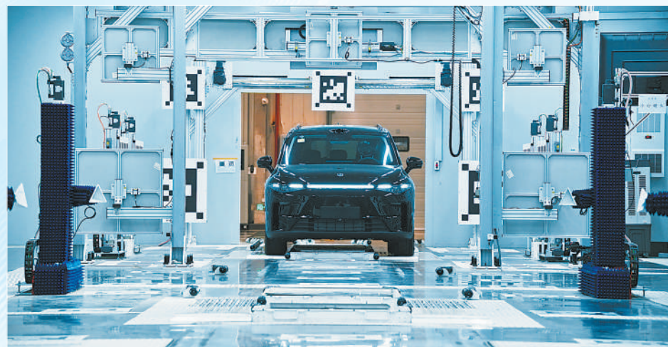
在零跑汽车无人化自检车间,车辆下线后由AI完成全流程质检,提升生产效率。 王岗摄(人民视觉)
